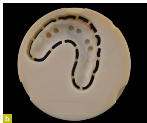
Abb. 11a und b Das gefräste Set-up vor dem Heraustrennen aus dem Blank.
