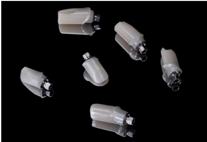
Abb. 7 Die gefrästen Zirkonoxidkappen (nach Reinigung und Aktivierung mit Kaltplasma) sind mit den Titanbasen verklebt.
