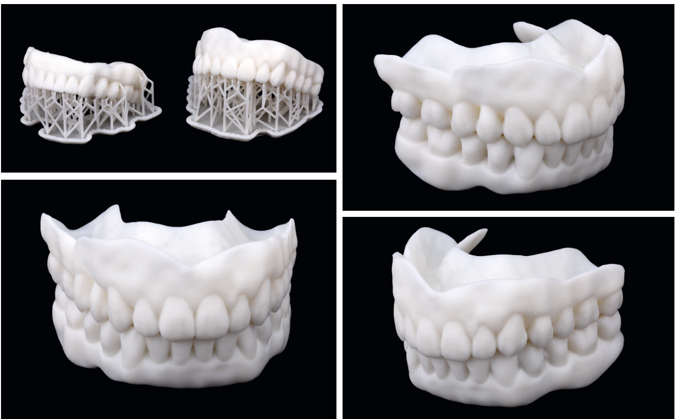
19 bis 22 Die digital hergestellten Bissprothesen wurden aus weißem Resin 3D-gedruckt
