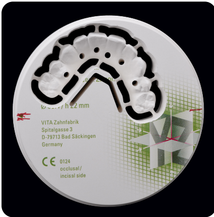
^ 03 Die Konstruktion nach dem Herausfräsen in der Ronde
