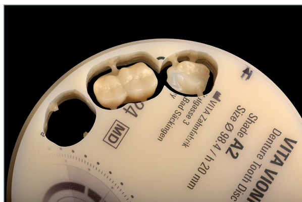
Das CAD/CAM-gestützt gefertigte Zahnmaterial in der VITA VIONIC DENT DISC multiColor.
