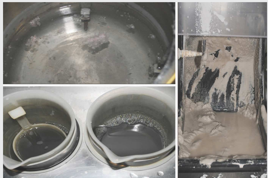
Abb. 3: Verunreinigtes Wasser durch Neuanfertigungen und Reparaturen im Drucktopf (links oben) und Ultraschallreinigungsgerät (links unten), sowie feuchtes Bimssteinmehl zur Politur (rechts). Wärme und feuchtes Milieu, der ideale Keimboden.
