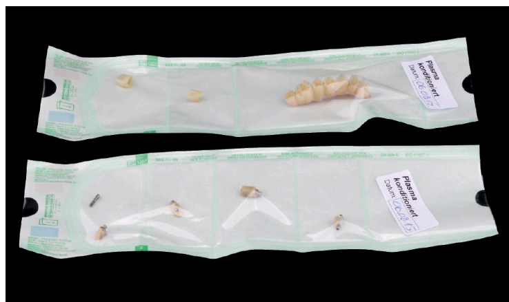
◉ Wird seit Jahren konsequent bei jeder Arbeit umgesetzt: die vielfältigen Anwendungen der Niederdruck-Plasma-Technologie. Oberflächenkonditionierung von Gerüsten vor der Verblendung und Verklebung und eingeschweißt nach Mikroreinigung und Plasma-Sterilisation für die Auslieferung.
