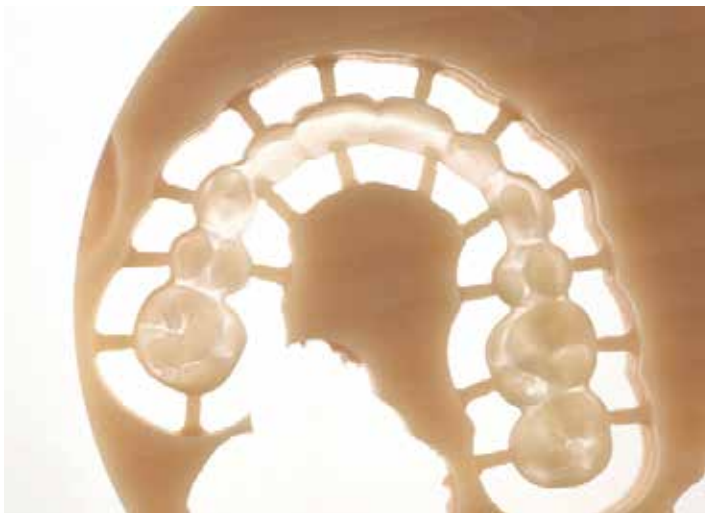
Q28 und Q29 ... und frästen es anschließend aus einer PMMA-Ronde aus, bevor wir es in die Praxis zur Anprobe schickten
