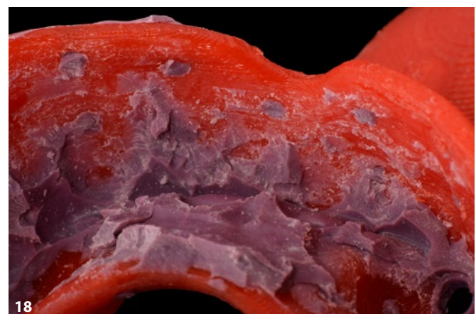
Abb. 13 bis 16 Für die ersten Löffel kombinierten die Autoren in der Software ein Schienenmodul mit einem extra konstruierten Griff. Später brachte Zirkonzahn eine Gratissoftware auf den Markt. Abb. 17 und 18 Druckerstrategien: Den Filamentdrucker kann man so einstellen, dass die Löffeloberfläche retentiv wird und somit die ideale Oberfläche für das Abformmaterial bietet.
