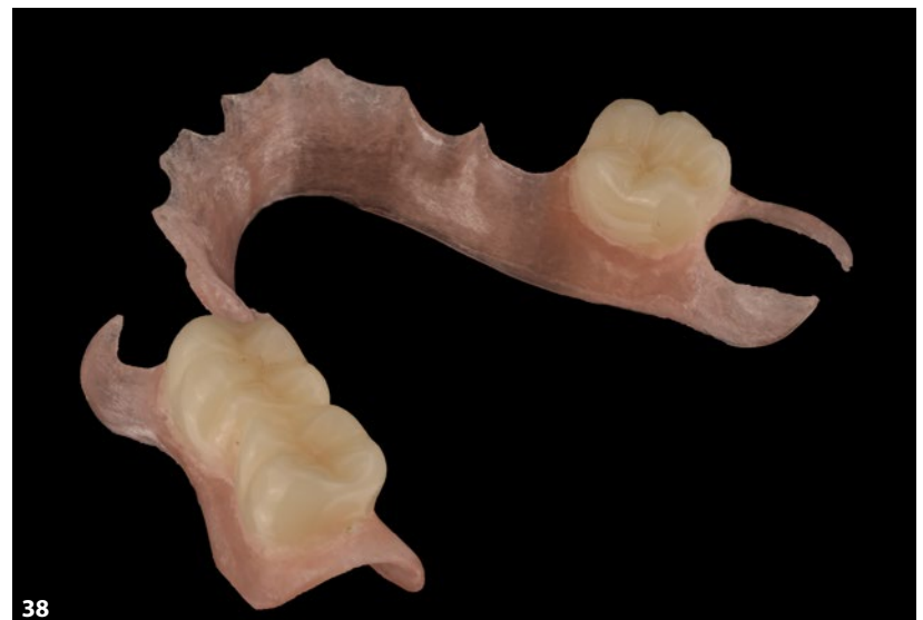
Abb. 34 Vielversprechend ist das Drucken von Provisorien/Langzeitprovisorien aus flexiblem Filament, wie z. B. PET oder Polyamid. Testdruck aus Polyamid/Nylon (FFF-Verfahren). Abb. 35 Druckergebnis eines dentalen Polyamid-Drucks im Größenvergleich zum 1,75 mm Filament-Draht. Abb. 36 Größenvergleich zu einem menschlichen Haar (etwa 0,05 bis 0,08 mm). Abb. 37 und 38 Testdruck von Langzeitprovisorien aus Dental-Polyamid. Die Zähne können gefräst, gedruckt oder als Konfektionszähne in die Basis eingearbeitet werden. Da Polyamid Wasser aufnimmt, ist diese doch etwas raue Oberfläche noch nicht befriedigend, da Verfärbungen und unangenehme Gerüche auftreten können.
