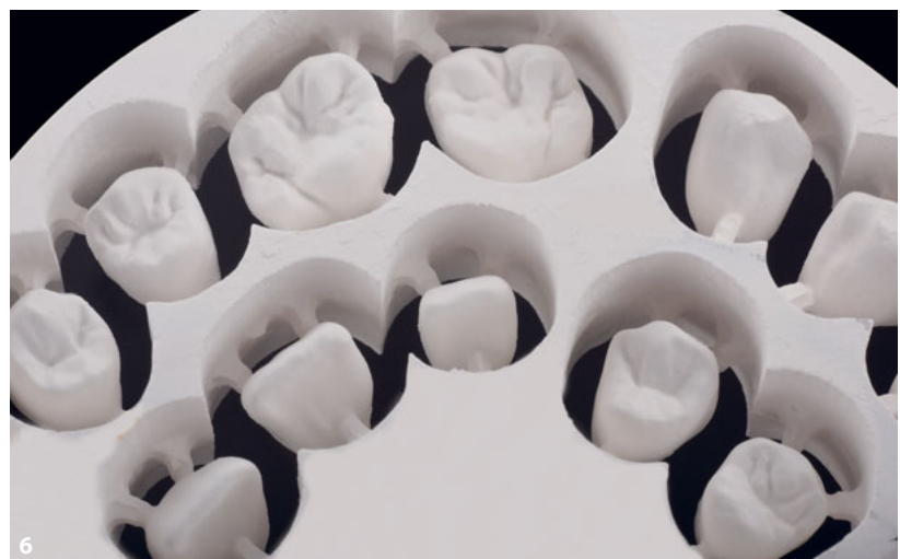
Abb. 5 Analoges Abformen ist immer ein fehlerbehafteter Prozess, bei dem die Abformmasse kontrahiert und der Modellwerkstoff expandiert und sich so die Fehler summieren. Abb. 6 Der Weg zu Full-Contour-Restaurationen führt nach dem Designen und Fräsen ...
