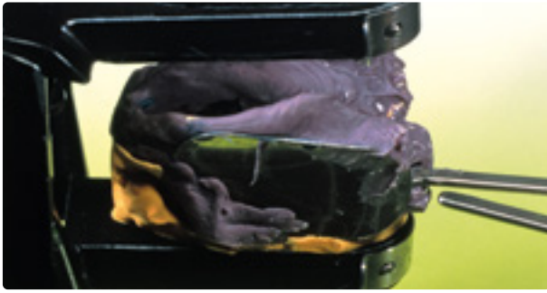
^ 09 Zuerst wird der Unterkiefer mit gerade einmal 50g Gips ausgegossen.
