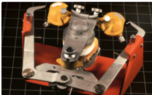
^ 39 Die Modelle wurden mittels eines arbiträren Gesichtsbogens schädelbezogen einartikuliert.
