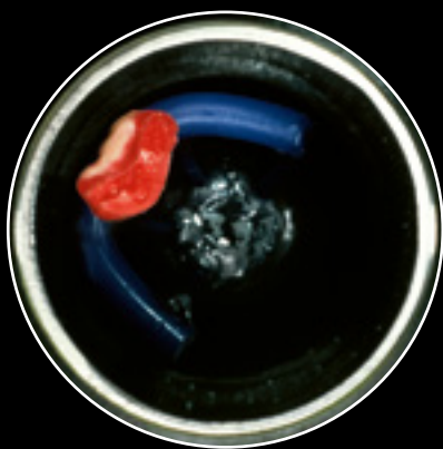
^ 26 Die Modellation wird zum Einbetten vorbereitet. Eingebettet wurde mit einer gipsgebundenen Einbettmasse, die auch in der Schmuckindustrie zum Einsatz kommt.
